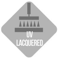
U.V. Lacado: el acabado U.V. permite proporcionar un acabado en alto brillo de gran dureza.
